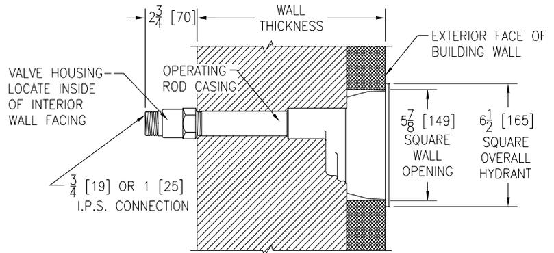
**ECOLOtrol WALL HYDRANT WITH CERAMIC DISC**
